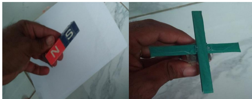
Figura 10: a) Imã em forma de barra b) Imã unido aos palitos com fita dupla face.
