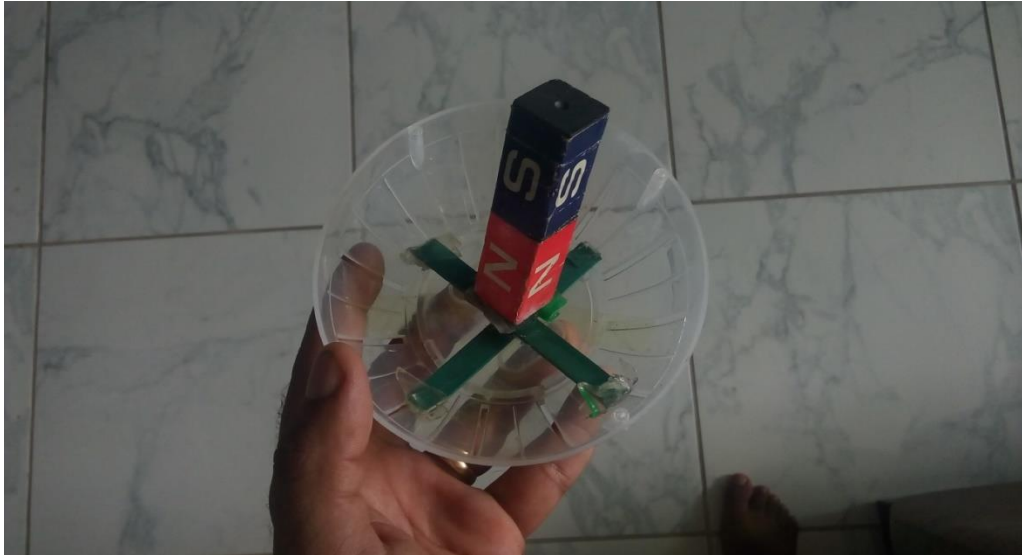
Figura11: Imã e seus suportes feitos de palitos fixados no globo com fita dupla face.
