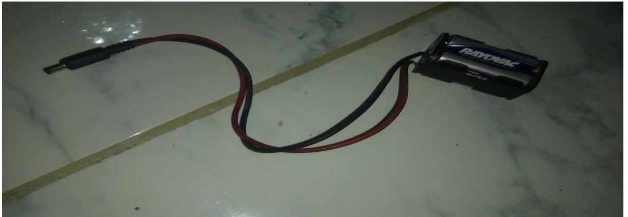
Figura 26: Fonte de alimentação: suporte para quatro pilhas AA de 1.5 V.
