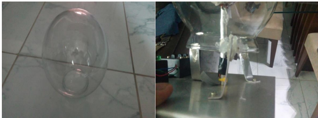
Figura 24: Globo de vidro de 100 mm de diâmetro à direita o globo fixo nos suportes com silicone.
