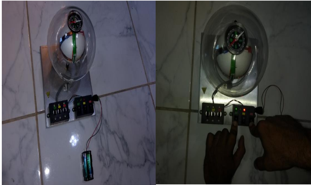
Figura 30 (a) Sem corrente elétrica nas espiras, o ponteiro da bússola aponta no sentido do campo magnético terrestre. (b) O campo magnético resultante devido a correntes elétricas em duas espiras (verde e azul), pela regra da mão direita o campo na espira verde aponta para oeste e na espira vermelha aponta para o sul, pela soma de vetores o campo resultante aponta na direção sudoeste.
