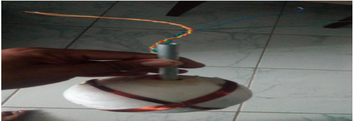
Figura 18: Coluna de alumínio 3/8" de diâmetro e 12 cm de altura colada na esfera com resina epóxi®.
