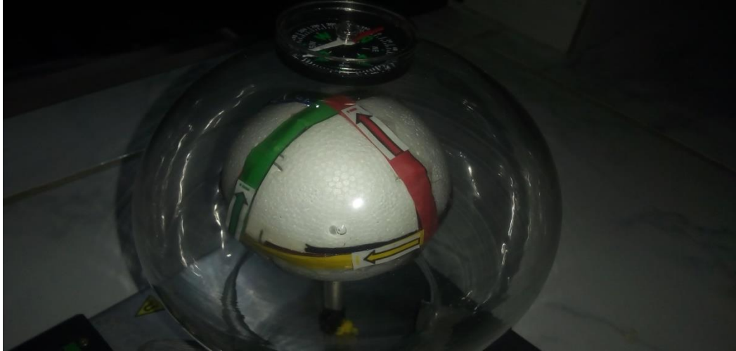
Figura 25: Bobinas adesivadas com cores diferentes: verde, Vermelha e amarelo para indicação do sentido da corrente.
