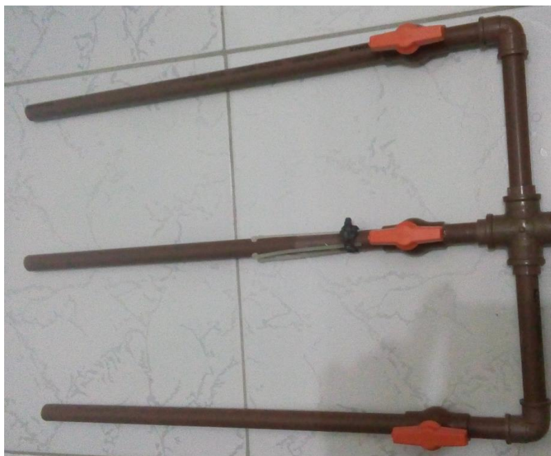
Figura 3.12- Condutores dos foguetes + junção dos condutores.
