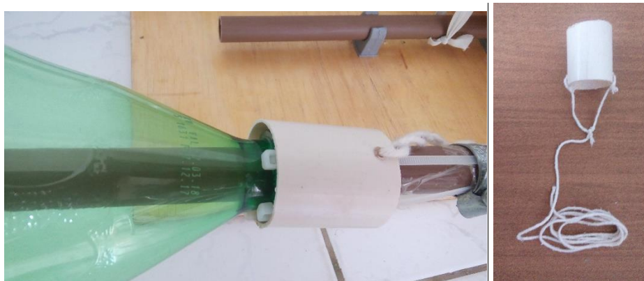
Figura 3.24- Montagem do acionador do foguete e (b) Peça de cano de PVC para esgoto com 40 mm de diâmetro e 4 cm de comprimento (acionador).
