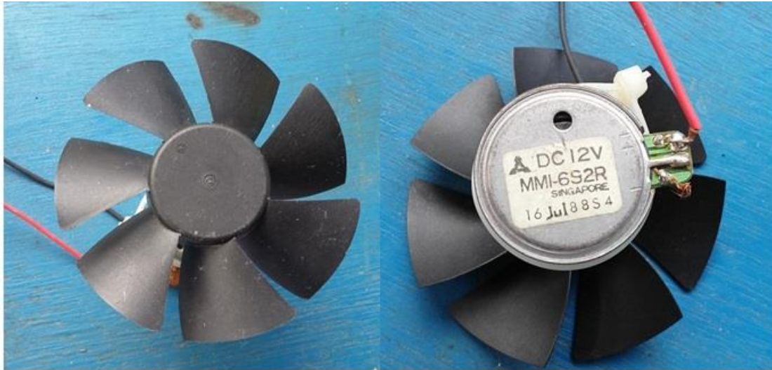
Fig5: (1) Cooler usado como turbina e(2) motor de 12 vots
