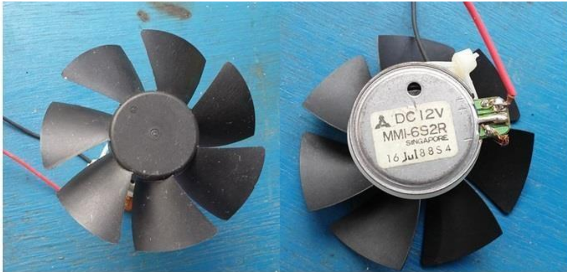
Fig. 35: (1) Cooler usado como turbina e(2) motor de 12 volts
