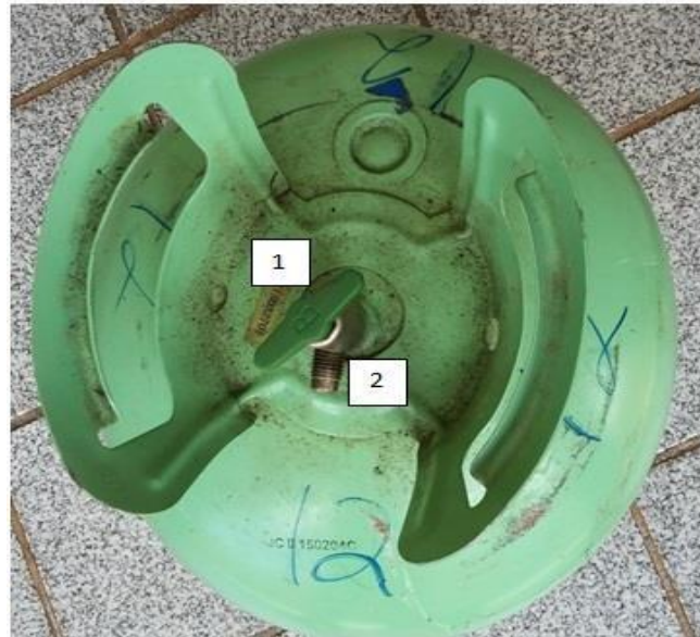
Fig. 32: vista superior do botijão de gás, (1) válvula de controle de saída de gás; (2) passagem de gás e local de acoplamento do cano para saída de vapor.
