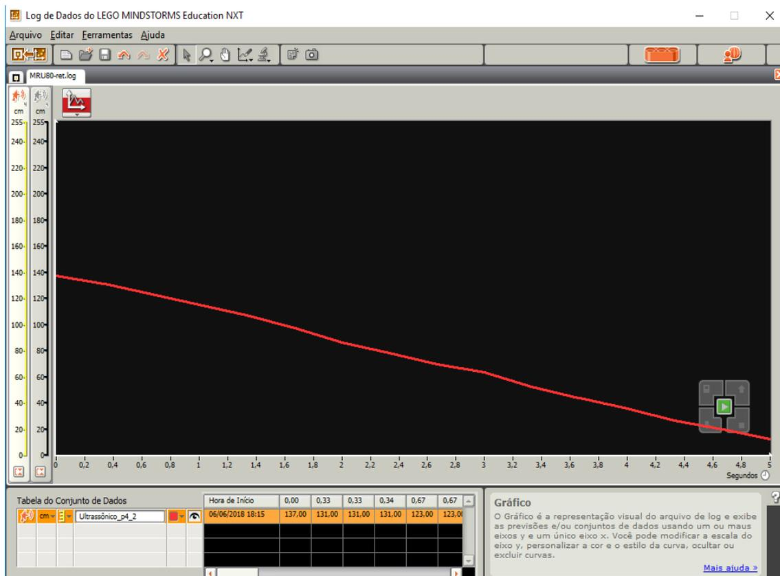
**Figura 33.** Deslocamento retrógrado em função do tempo para motor em 80% de potência
