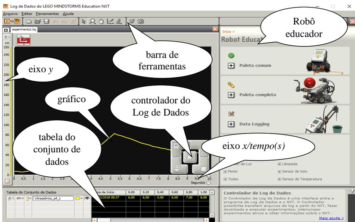
**Figura 6.** Interface da janela do Log de Dados LEGO MINDSTORMS
