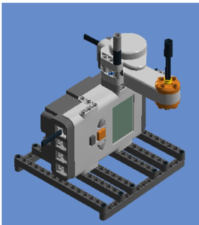
**10º Passo:** Angular beam 90degr. W.4 snaps, Tube Ø7,84 2m (4526982 e 4526985), Cross Axle 5,5 with stop 1m, Conn Bush W. Fric/Crossale e Lightsensor (conectar o cabo 1 ao sensor de luz)
