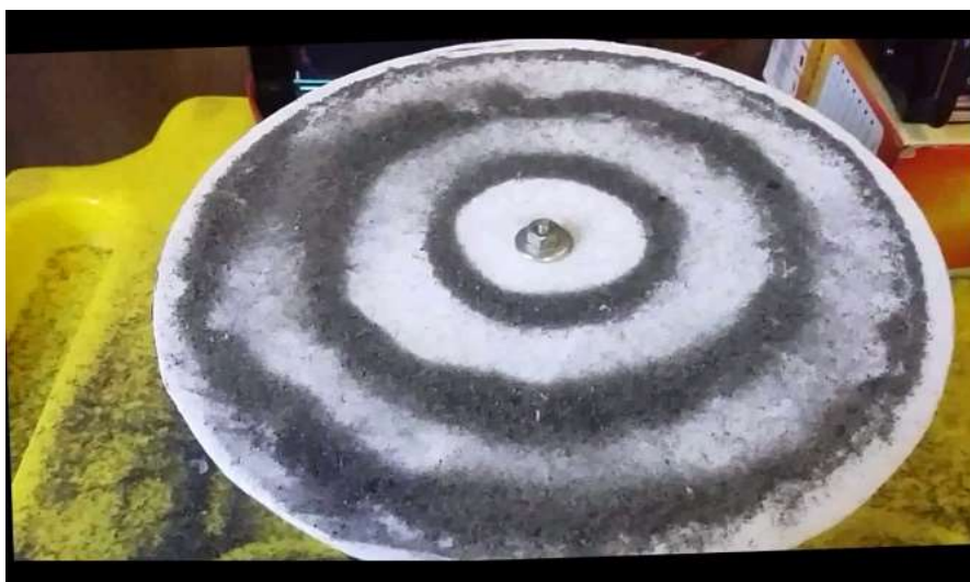
Figura 28 – Placa circular com raio igual a 20 cm, vibrando na frequência 1.500 Hz.
