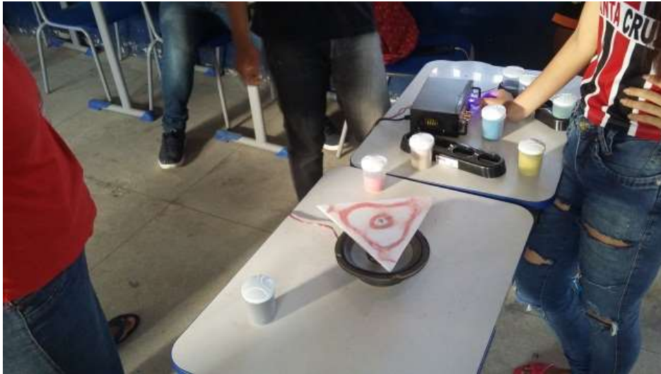
Foto 15 - Polvilhando a placa triangular com areia e observando a formação das Figuras de Chladni.
