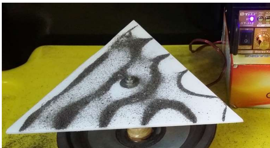
Figura 29 – Placa triangular com lados iguais a l = 20 cm, vibrando na frequência 2.100 Hz.
