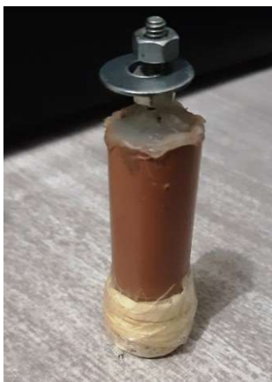
Figura 08 - Cano de PVC com parafuso fixador centrado.
