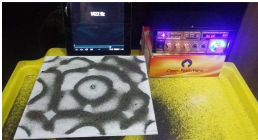
Figura 27 – Placa quadrada com lados a = b = 20 cm, vibrando na frequência 1.422 Hz.
