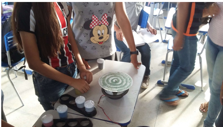
Foto 14 – Polvilhando a placa circular com areia e observando a formação das Figuras de Chladni.
