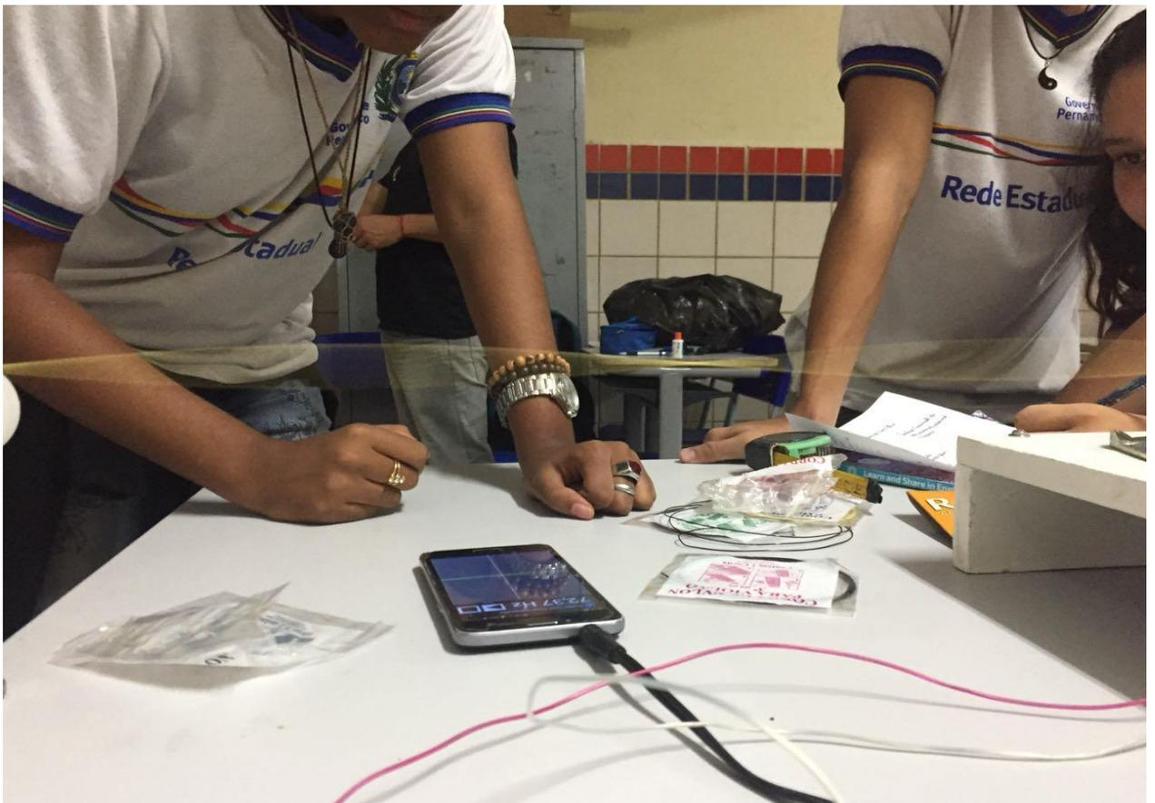
Figura 4.13: com o uso de aplicativo de celular gerador de áudio, obtenção da frequência do 2º harmônico.
