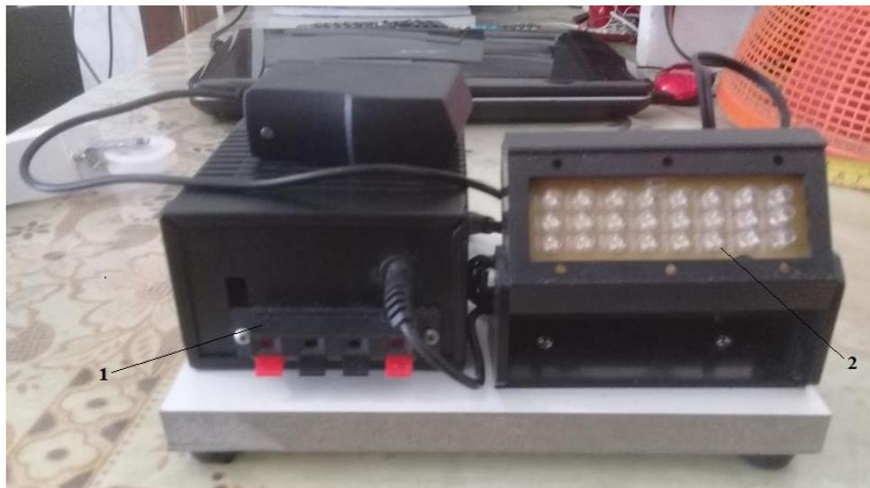
Figura 3.10: visão posterior da base de madeira com amplificador, estroboscópio e cabo de força
