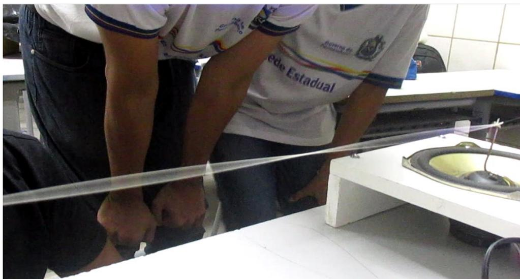
Figura 4.18: obtenção da frequência de 2º harmônico
