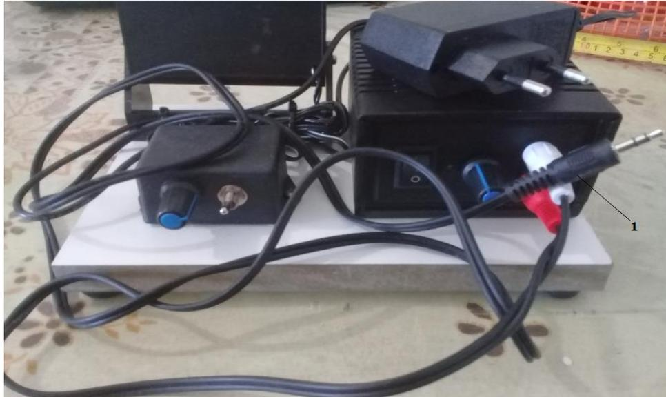
Figura 3.9: visão frontal da base com amplificador e cabo de áudio com as duas entradas RCA conectadas
