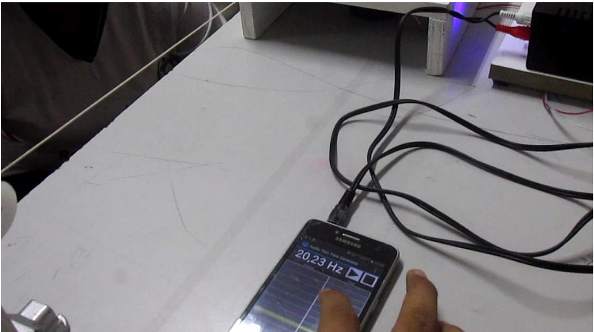
Figura 4.20: usando aplicativo de celular para achar as frequências dos harmônicos.
