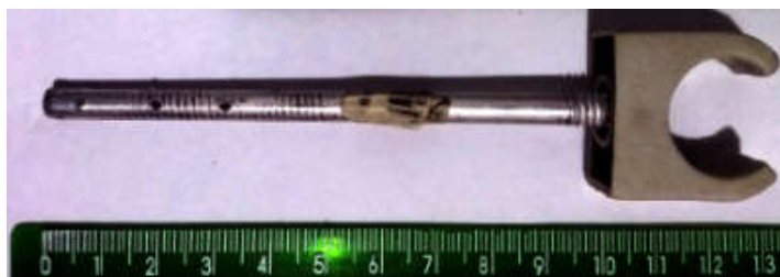
Figura 6.3 – Haste metálica conectada ao fixador de tubos de PVC.
