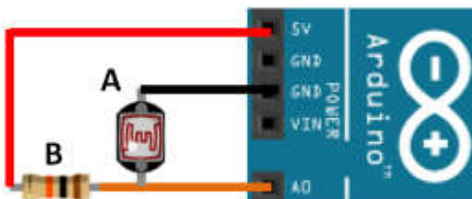
Figura 41 – Circuito elétrico de ligação do LDR ao Arduino.
