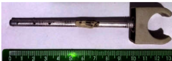
Figura 36 – Haste metálica conectada ao fixador de tubos de PVC.
