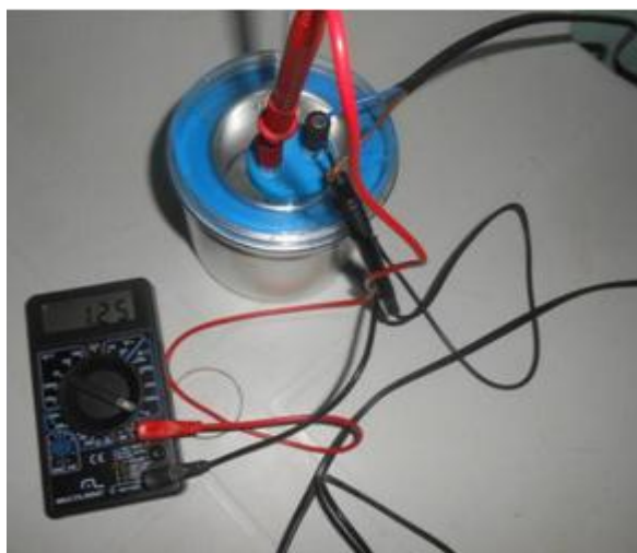
Figura A.9: Multímetro associado em série com o calorímetro.
