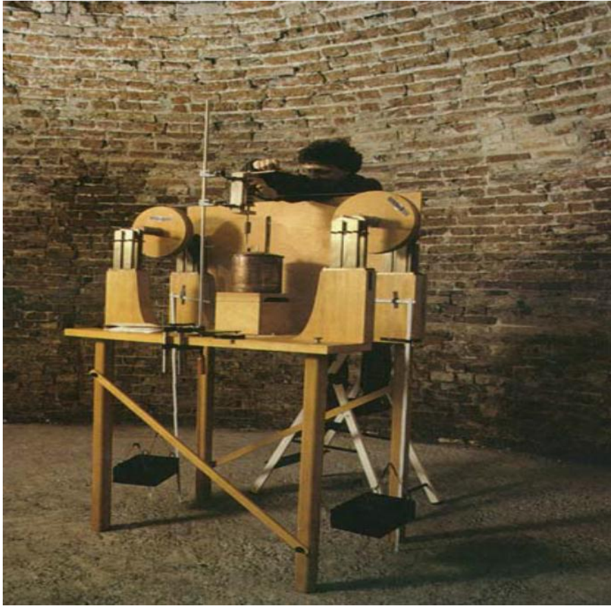
Figura 4.2: Réplica do aparato de Joule.
