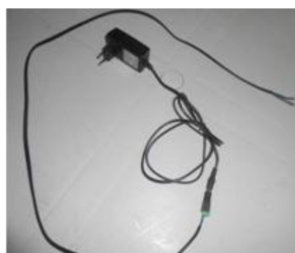
Figura A.7: Fonte AC/DC ligada ao fio de 1,20 m bifurcado.
