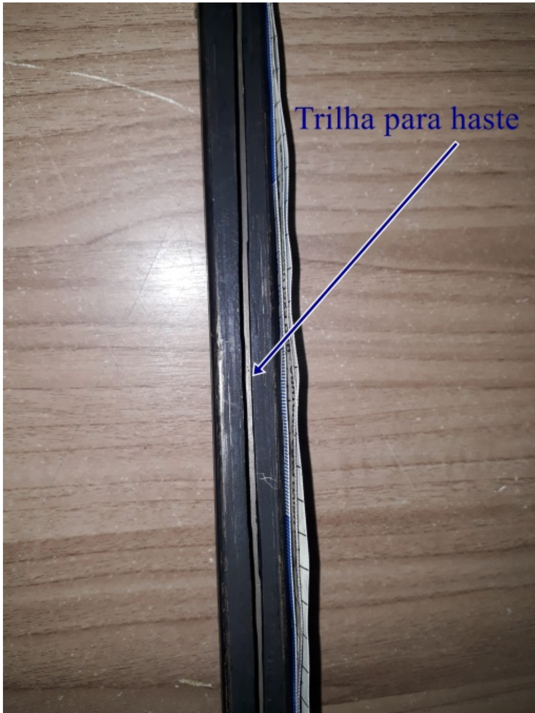
Figura 4.6 Trilha para guiar a haste de leitura.
