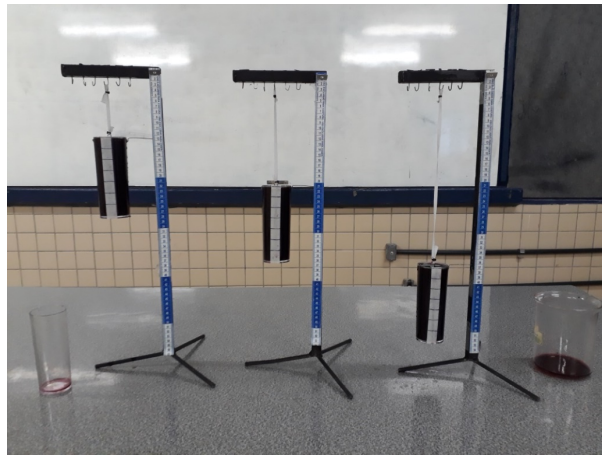
Figura 4.11 Elásticos com comprimentos iniciais de 18,0 cm, 9,0 cm e 4,5 cm.
