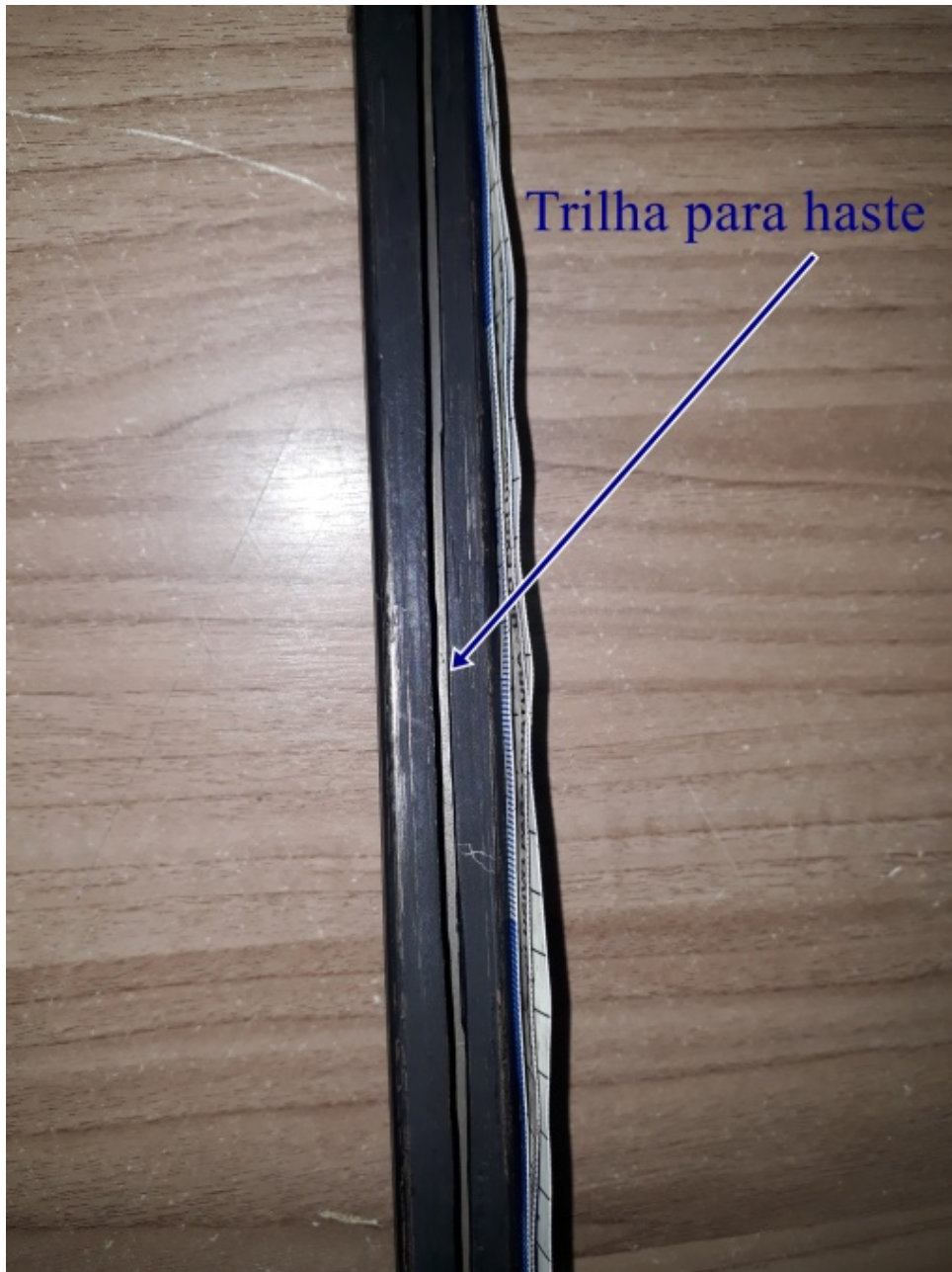
Figura A.7 Lateral do suporte com trilha guia.
