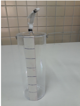
Figura A.8 Elástico preso à haste. Figura A.9 Liga de borracha presa à haste. Figura A.10 Copo graduado com haste.
