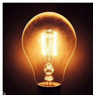
Figura 27 – Filamento de tungstênio de uma lâmpada incandescente emitindo luz a uma alta temperatura devido ao Efeito Joule.
