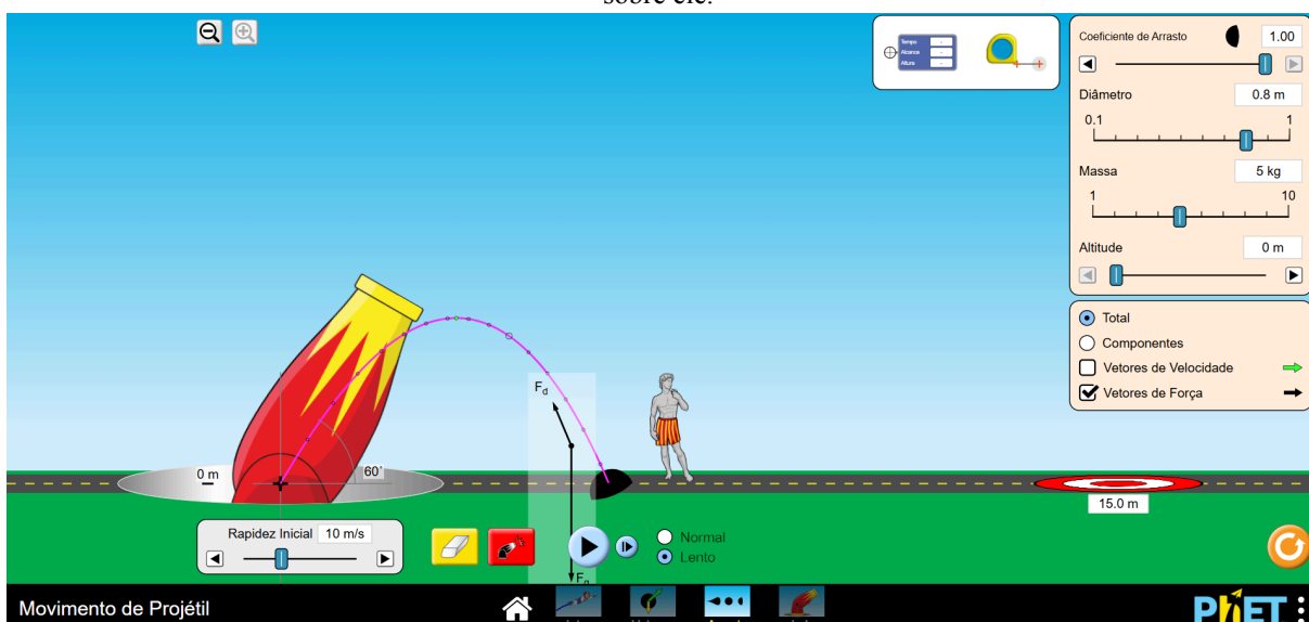
Figura 20: Lançamento de um objeto a 10 m/s e representação vetorial da força de resistência do ar que age sobre ele.
