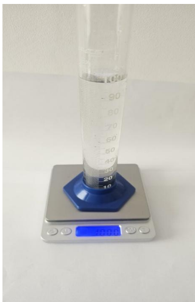
Figura 12 - Proveta graduada indicando volume de 100mL e massa de 100g
