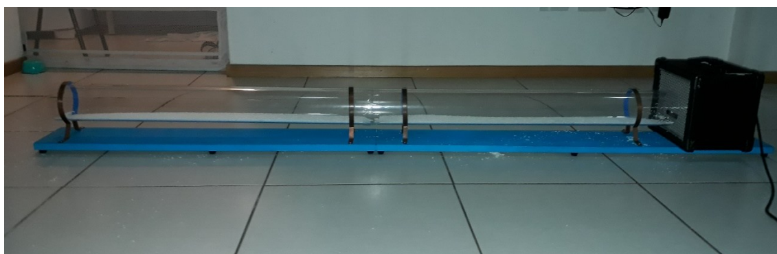
Figura 3.8. Aparato completo com os dois tubos unidos com fita adesiva transparente e caixa de som amplificada posicionada numa das extremidades do tubo.
