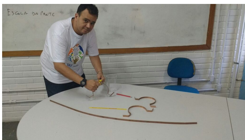
Figura 3.5. Confeção das abraçadeiras de cobre para fixação do tubo de acrílico na base de madeira.
