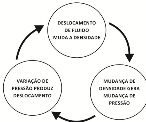
Figura 3.11. Mecanismo de propagação da onda sonora
