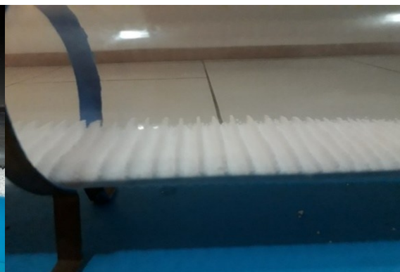
Figura 4.5. Segundo modo de vibração do tubo aberto.
